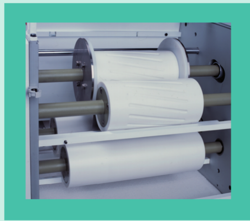
Quattro cilindri regolabili di laminazione Four adjustable laminating cylinders Quatre cylindres de laminage réglables Vier Walzylindern regulierbaren Cuatro cilindros de laminación regulables
