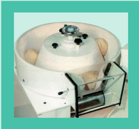
Pezzi d'impasto arrotondati dal moto della campana mobile Dough pieces rounded off by the moving bell Morceaux de pâte arrondis par le mouvement de la cloche mobile Die Teigstücke werden durch die Bewegung der Glocke abgerundet Trozos de empaste redondeados por el movimiento de la campana móvil
